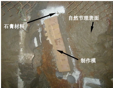
图 3 拓取自然节理粗糙面 Fig.3 Molding the surface profile of nature joint
